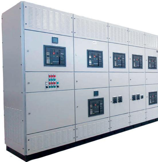
Низковольтное комплектное устройство «Аврора» (далее НКУ) предназначено для приема и распределения электрической энергии трехфазного переменного тока частотой 50Гц напряжением 0,4 кВ и 0,69 кВ в сетях с глухозаземленной или изолированной нейтралью, управления и защиты электрооборудования от перегрузок и токов короткого замыкания.
